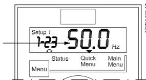
Abbildung 7.5 Anzeige des Werts des ausgewählten Parameters.
