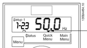
Abbildung 7.9 Anzeige des Quick-Menü-Modus
